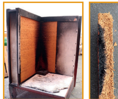
Essais de tenue au feu d'un enduit terre-chanvre
